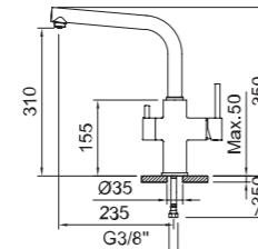
Fregadero 3 vías para equipos de tratamiento del agua, con 2 salidas de agua, caño giratorio y flexibles 3/8" >350mm.
