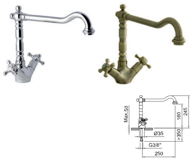
Fregadero bimando con aireador, caño conformado giratorio y flexibles 3/8" >350mm.
