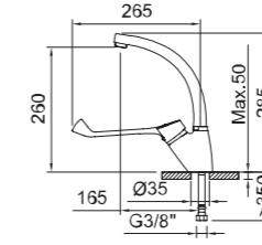
Fregadero monomando con aireador, palanca gerontológica, caño conformado giratorio y flexibles 3/8" >350mm.
