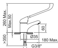
Lavabo monomando con palanca gerontológica, aireador y flexibles 3/8" >350mm.
