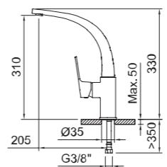
Fregadero monomando con aireador, caño fundido giratorio y flexibles 3/8" >350mm.
