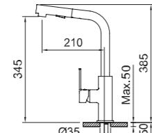
Fregadero monomando con aireador, extraíble, caño giratorio y flexibles 3/8" >350mm.
