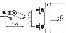
Baño-ducha termostático con aireador e inversor incorporado en la maneta de caudal.
