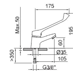
Lavabo monomando con palanca gerontológica, aireador y flexibles 3/8" >350mm.
