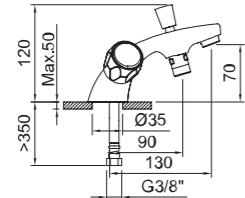
Baño-ducha bimando monotru con aireador, inversor automático y flexibles 3/8" >350mm.
