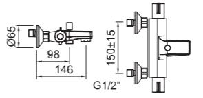
Baño-ducha termostático con aireador e inversor automático.
