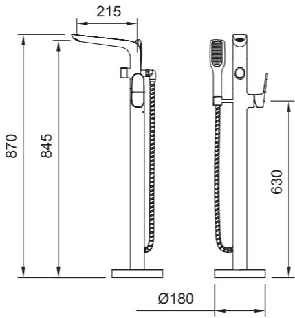
Baño-ducha monomando fijación suelo con aireador e inversor.
