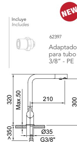
Fregadero 3 vías extraíble para equipos de tratamiento del agua, con 2 salidas de agua, caño giratorio y flexibles 3/8" >350mm.
