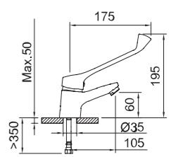
Lavabo monomando con palanca gerontológica, aireador y flexibles 3/8" >350mm.
