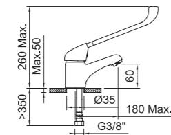
Lavabo monomando con palanca gerontológica, aireador y flexibles 3/8" >350mm.
