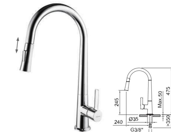
Fregadero monomando con aireador, extraíble, caño giratorio y flexibles 3/8" >350mm.
