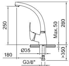
Fregadero monomando con aerador, caño conformado giratorio y flexibles 3/8" >350mm.
