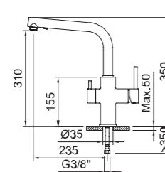
Fregadero 3 vías para equipos de tratamiento del agua, con 2 salidas de agua, caño giratorio y flexibles 3/8" >350mm.
