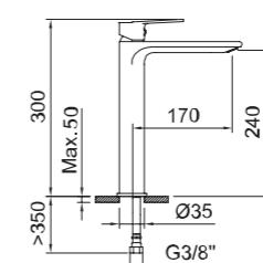
Lavabo alto monomando con aireador y flexibles 3/8" >350mm.
