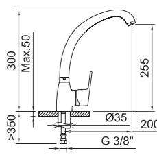
Fregadero monomando con aireador, caño conformado giratorio y flexibles 3/8" >350mm.
