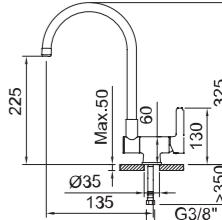
Fregadero monomando con aireador, caño abatible 180°, caño conformado giratorio y flexibles 3/8" >350mm.
