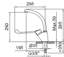
Fregadero monomando con aireador, palanca gerontológica, caño giratorio y flexibles 3/8" >350mm.
