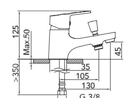
Baño-ducha monomando monotru con aireador, inversor automático y flexibles 3/8" >350mm.
