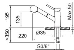
Fregadero monomando con aireador, extraíble, caño giratorio y flexibles 3/8" >350mm.
