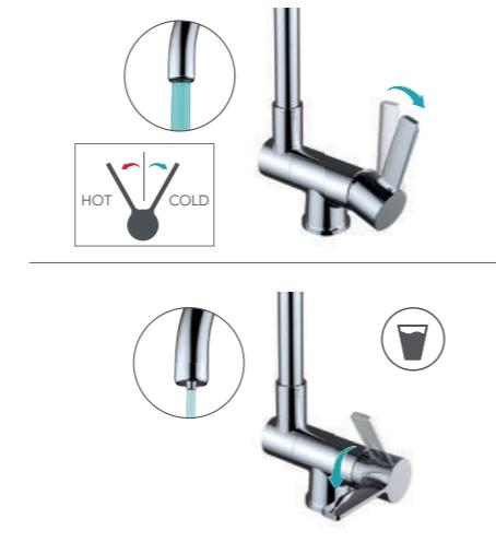
Fregadero monomando 3 vías para equipos de tratamiento del agua con 2 salidas de agua, caño abatible, caño giratorio y flexibles 3/8" >350mm.
