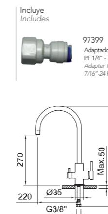
Fregadero 3 vías para equipos de tratamiento del agua, con 2 salidas de agua, caño giratorio y flexibles 3/8" >350mm.
