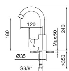
Lavabo monomando con aireador, caño giratorio y flexibles 3/8" >350mm.
