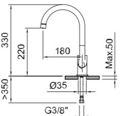
Fregadero monomando con aireador, caño conformado giratorio y flexibles 3/8" >350mm.
