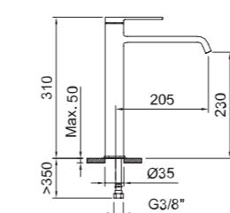
Lavabo alto monomando con aireador y flexibles 3/8" >350mm.
