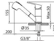
Fregadero monomando con aireador, extraíble, caño giratorio y flexibles 3/8" >350mm.
