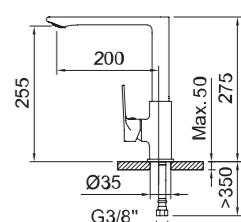
Fregadero monomando con aireador, caño fundido giratorio y flexibles 3/8" >350mm.
