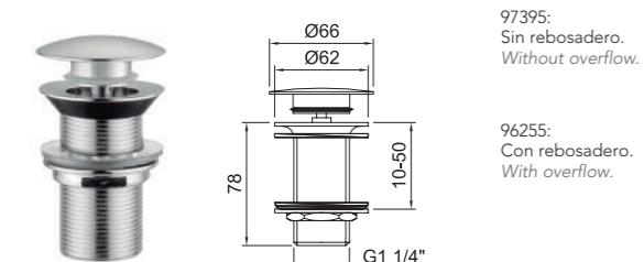
Válvula desagüe sistema quick-clac con rebosadero 1 1/4".
