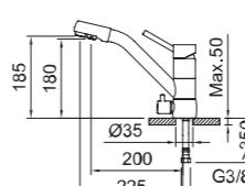
Fregadero 3 vías para equipos de tratamiento del agua, con 2 salidas de agua, caño giratorio y flexibles 3/8" >350mm.
