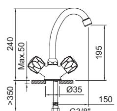
Fregadero bimando con aireador, caño conformado giratorio y flexibles 3/8" >350mm.
