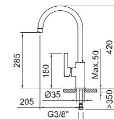
Fregadero monomando 3 vías para equipos de tratamiento del agua, con 2 salidas de agua, caño giratorio y flexibles 3/8" >350mm.
