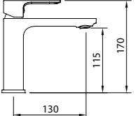
Mezclador con aireador y flexibles M-10 3/8" x 500 mm.
