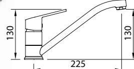
Mezclador con aireador, caño giratorio y flexibles M-10 3/8" x 370 mm.
