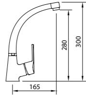
Mezclador con aireador, caño giratorio y flexibles M-10 3/8" x 370 mm.
