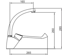
Fregadero con maneta gerontológica con mezclador con aireador y flexibles M-10 3/8" x 370 mm con palanca gerontológica.
