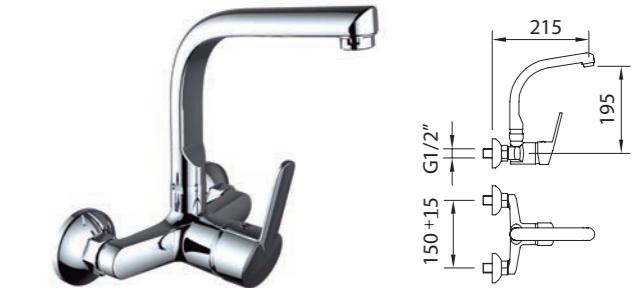
Mezclador mural con aireador, caño conformado giratorio superior.
