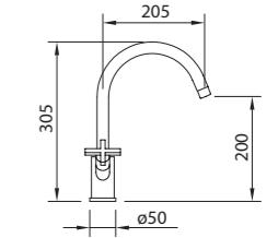
Mezclador con aireador, caño giratorio, flexibles M-10 3/8" x 370 mm. Mixer with aerator, swivel spout, flexible hoses M-10 3/8" x 370 mm. Mélangeur évier à béc orientable, eaérateur, raccords flexibles M-10 3/8" x 370 mm
