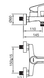
Mezclador con aireador baño-ducha, inversor automático.
