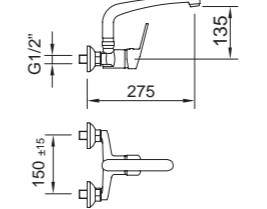
Mezclador mural con aireador, caño conformado giratorio superior.
