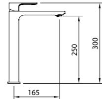
Mezclador alto con aireador y flexibles M-10 3/8" x 370 mm.
