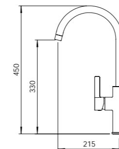
Mezclador con aireador, caño giratorio, flexibles M-10 3/8" x 500 mm.
