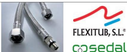
Longitud de 370 mm, según Norma EN 817. Macho roscado fabricado con CW617 ( $Sn<0,3\%$ ). Trenzado acero Inoxidable AISI 304. Tubo de goma EPDM o PEX, libre de migración de partículas nocivas. Amplia cobertura de certificaciones internacionales. Resisten presiones estáticas de más de 130 bar (13 MPa).
