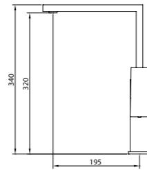
Mezclador con aireador, caño fundido giratorio, flexibles M-10 3/8" x 500 mm.
