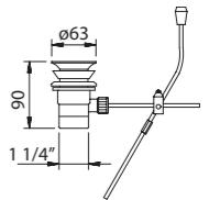
Desagüe automático de 1 1/4" con tirador para lavabo y bidé.
