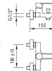
Mezclador con aéreador baño-ducha, inversor automático.
