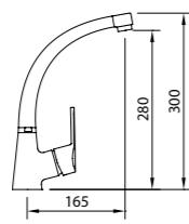
Mezclador con aireador, caño conformado giratorio y flexibles M-10 3/8" x 370 mm.
