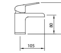
Mezclador, rompeaguas y flexibles M-10 3/8" x 420 mm.
