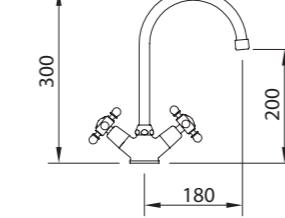
Mezclador con aireador, caño conformado giratorio, flexibles M-10 3/8" x 370 mm. Mixer with aerator, swivel tube spout, flexible hoses M-10 3/8" x 370 mm. Mélangeur évier, béc orientabl, eaérateur, raccords flexibles M-10 3/8" x 370 mm
