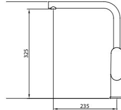
Mezclador con aireador, caño fundido giratorio, flexibles M-10 3/8" x 500 mm.
