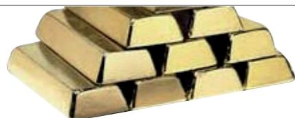
La grifería Clever utiliza aleaciones puras, con una mínima cantidad de impurezas. El porcentaje de plomo es muy bajo ( $Pb<1,6\%$ ) en consonancia con las directrices de consumo de agua potable. La aleación exenta de poros logra un pulido de alta calidad. Ausencia total roturas.
