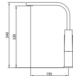
Mezclador con aireador, caño fundido giratorio, flexibles M-10 3/8" x 500 mm.
