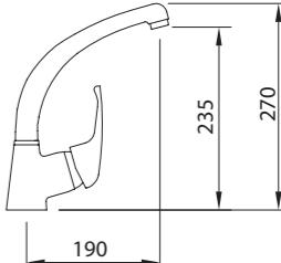
Mezclador con aireador, caño fundido giratorio, flexibles M-10 3/8" x 370 mm.
