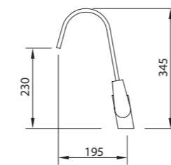
Mezclador con rompeaguas, caño conformado giratorio, flexibles M-10 3/8" x 370 mm.
