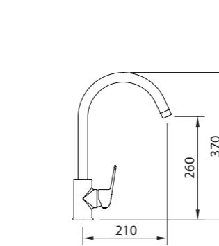
Mezclador con aireador, caño conformado giratorio y flexibles M-10 3/8" x 370 mm
