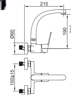
Mezclador mural con aireador, caño conformado giratorio superior.
