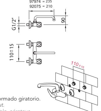
Mezclador con aireador, caño conformado giratorio.
