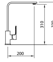
Mezclador con aireador, caño tubo giratorio, flexibles M-10 3/8" x 370 mm.
