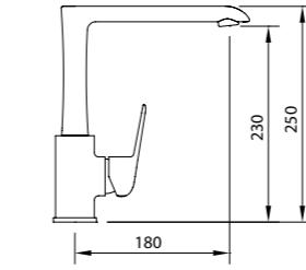
Mezclador con aireador, caño fundido giratorio y flexibles M-10 3/8" x 370 mm.
