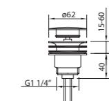
Válvula desagüe Universal. Metálico.
