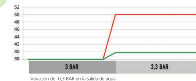
Cuando el limitador de caudal se usa con un cartucho standard, el usuario puede experimentar cambios significativos en la temperatura del agua.
