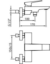
Mezclador con aireador baño-ducha, inversor integrado.
