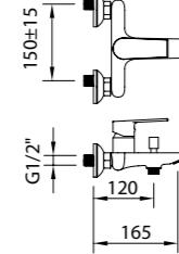
Mezclador con aireador baño-ducha, inversor automático.
