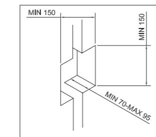
Sistema de sujeción de la placa (embellecedor).
