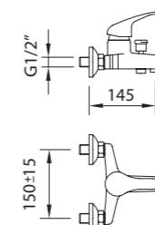
Mezclador con aireador baño-ducha, inversor automático.
