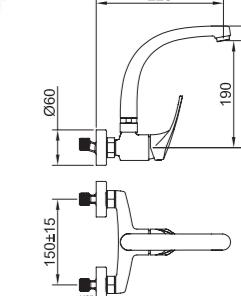
Mezclador mural con aireador, caño conformado giratorio superior.
