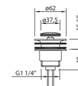
Válvula desagüe Universal. Metálico.
