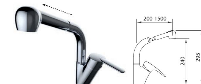
Mezclador con aireador, caño giratorio, ducha extraíble con pulsador para lavavajillas, enlaces de alimentación flexibles M-10 3/8" x370 mm.
