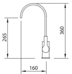
Mezclador con rompeaguas, caño giratorio, flexibles M-10 3/8" x 370 mm.
