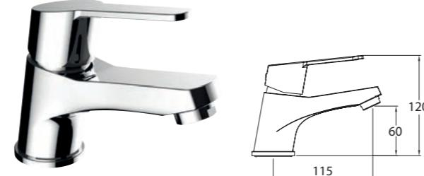
Mezclador con aireador y flexibles M-10 3/8" x 420 mm.
