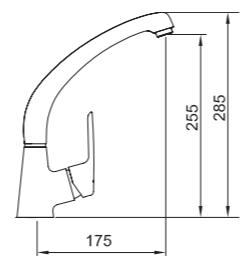
Mezclador con aireador, caño fundido giratorio, flexibles M-10 3/8" x 370 mm.
