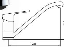
Mezclador con aireador, caño giratorio y flexibles M-10 3/8" x 370 mm.
