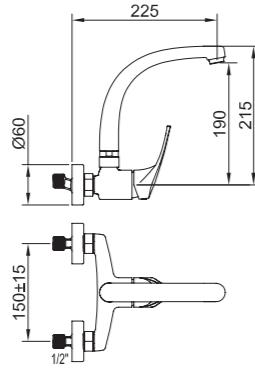
Mezclador mural con aireador, caño conformado giratorio superior.
