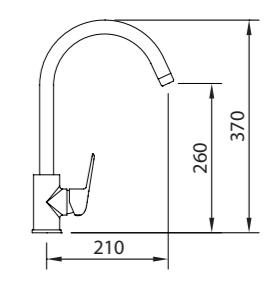
Mezclador con aireador, caño conformado giratorio y flexibles M-10 3/8" x 370 mm.
