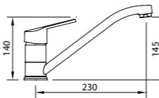
Mezclador con aireador, caño giratorio y flexibles M-10 3/8" x 370 mm.
