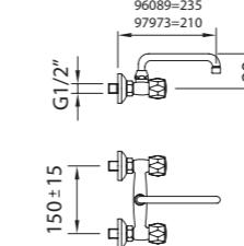
Mezclador con aireador, caño conformado giratorio.
