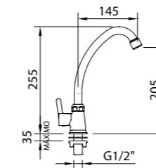
Con caño conformado giratorio con aireador.
