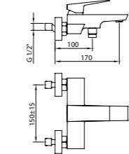
Mezclador con aireador baño-ducha, inversor integrado.
