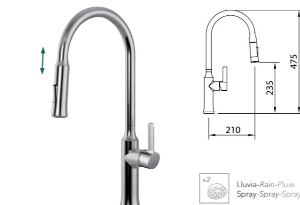
Mezclador con aireador, caño giratorio, ducha extraíble con pulsador para lavavajillas, enlaces de alimentación flexibles M-10 3/8" x 370 mm.
