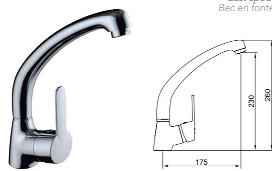
Mezclador con aireador, caño fundido giratorio, flexibles M-10 3/8" x 370 mm.
