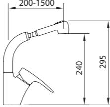
Mezclador con aireador, caño giratorio, ducha extraíble con pulsador para lavavajillas, enlaces de alimentación flexibles M-10 3/8" x370 mm.
