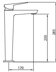
Mezclador alto con aireador y flexibles M-10 3/8" x 370 mm.
