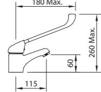
Mezclador con aireador,con palanca gerontológica y flexibles M-10 3/8" x 370 mm.
