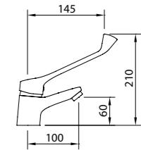
Mezclador con aireador, con palanca gerontológica y flexibles M-10 3/8" x 370 mm.
