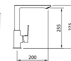
Mezclador con aireador, caño fundido giratorio, flexibles M-10 3/8" x 420 mm.
