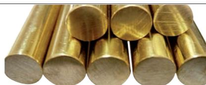
Latón europeo estampado de extrusión de primera calidad. Norma UE EN 12.164/5. El latón de estampación contiene un porcentaje muy alto de cobre ( $Cu\sim60\%$ ). El porcentaje de estaño es muy bajo ( $Sn<0,3\%$ ), evitando la rigidez y posibles daños.
