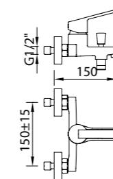
Mezclador con aireador baño-ducha, inversor automático.
