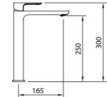
Mezclador alto con aireador y flexibles M-10 3/8" x 370 mm.
