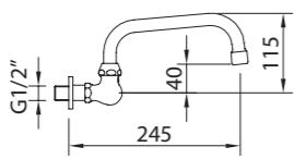
Grifo de pared con aireador y caño conformado giratorio.
