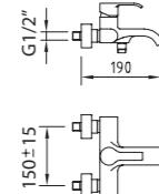
Mezclador baño-ducha, aireador, inversor integrado
