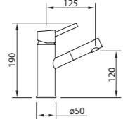
Mezclador con aireador y flexibles M-10 3/8" x 370 mm.
