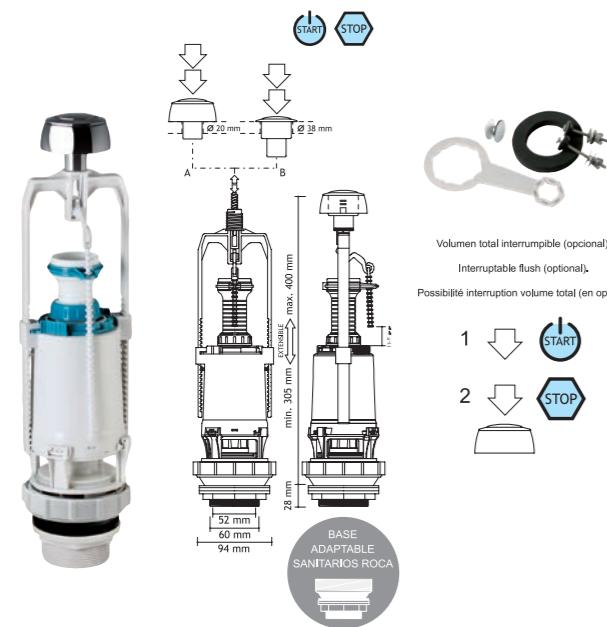
Descarga eco-control interrumpible. Fácil montaje.
