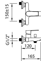
Mezclador con aireador baño-ducha, inversor automático.
