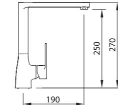
Mezclador con aireador, caño fundido giratorio, flexibles M-10 3/8" x 370 mm.
