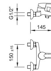
Mezclador con aireador baño-ducha, inversor automático.
