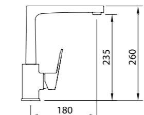
Mezclador con aireador, caño fundido giratorio, flexibles M-10 3/8" x 370 mm.
