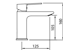
Mezclador con aireador y flexibles M-10 3/8" x 420 mm.
