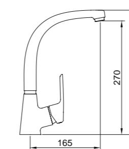
Mezclador con aireador, caño conformado giratorio, flexibles M-10 3/8" x 370 mm.
