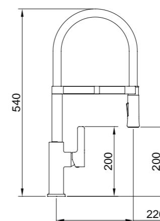
Mezclador 3 vías para equipos de tratamiento del agua, con 2 salidas de agua, flexibles M-10 3/8" x 420 mm.
