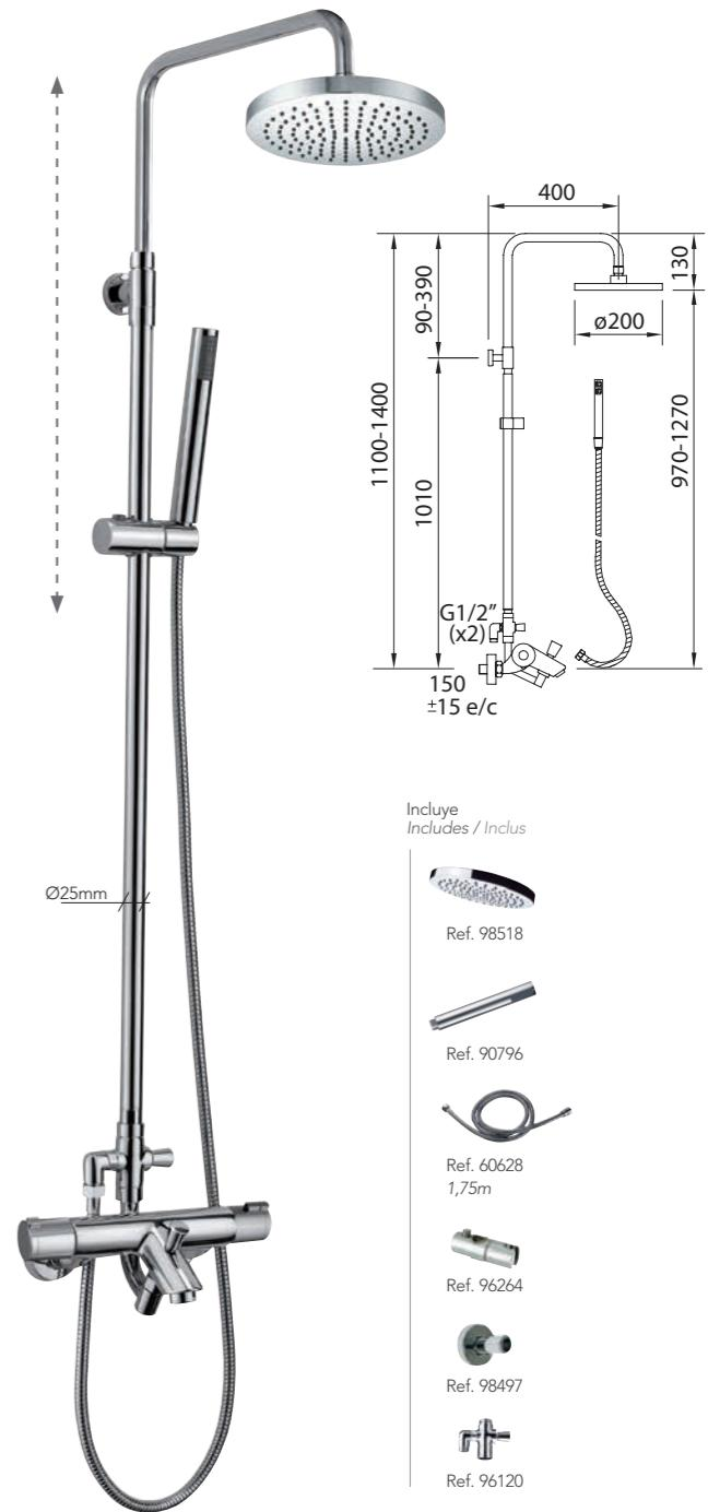
Mezclador termostático de baño-ducha con tubo extensible (98517), soporte articulado deslizante.
