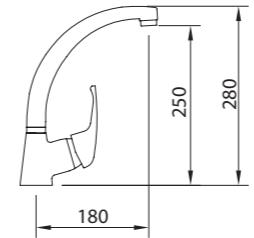
Mezclador con aireador, caño conformado giratorio, flexibles M-10 3/8" x 370 mm.
