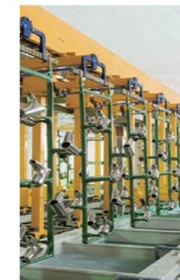
Extra Cromado, proceso de cromado compuesto por 44 pasos que garantizan la resistencia a la corrosión. La superficie debe resistir una prueba de laboratorio que consiste en soportar más de 200 horas de niebla salina sin que se aprecien defectos.
