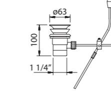
Desagüe automático de 1 1/4" con tirador para lavabo y bidé.
