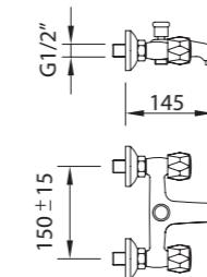
Mezclador con aireador baño-ducha, inversor automático.
