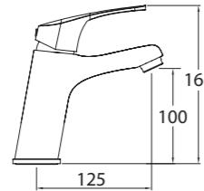
Mezclador con aireador y flexibles M-10 3/8" x 500 mm.
