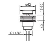
Válvula desagüe Universal. Metálico.
