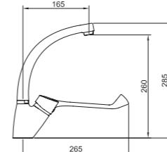
Fregadero con maneta gerontológica con aireador y caño conformado giratorio y flexibles M-10 3/8" x 370 mm con palanca gerontológica.
