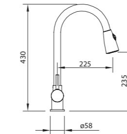
Mezclador con caño giratorio, ducha extraíble con pulsador para lavavajillas, enlaces de alimentación flexibles M-10 3/8" x 370 mm.
