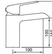
Mezclador con aireador y flexibles M-10 3/8" x 500 mm.
