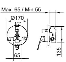
**BAÑO DUCHA EMPOTRAR 2 VÍAS / Wall mounted bath-shower mixer 2 outlet diverter / Mitigeur à encastrer 2 voies**
