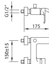
Mezclador baño-ducha, aireador, inversor automático.
