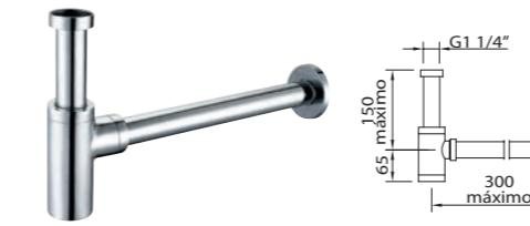
Sifón botella de 1 1/4" de lujo para lavabos de encima, longitud de tubo lateral hasta 300 mm, longitud del tubo vertical 150 mm, tubo de 32 mm Ø.
