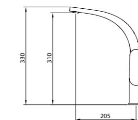
Mezclador con aireador, caño fundido giratorio, flexibles M-10 3/8" x 500 mm.
