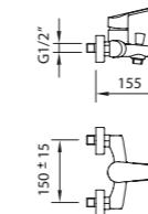
Mezclador con aireador baño-ducha, inversor automático.
