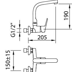
Mezclador mural con aireador, caño conformado giratorio superior.
