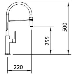
Mezclador con aireador, caño giratorio, enlaces de alimentación flexibles M-10 3/8" x 370 mm. / Mixer with aerator, handset and flexible hoses M-10 3/8" x 370 mm. / Évier à bec orientable, ressort de guidage renforcé. Livré avec raccords flexibles M-10 3/8" x 370 mm
