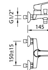
Mezclador con aireador baño-ducha, inversor automático.
