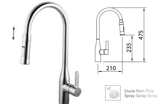
Mezclador con aireador, caño giratorio, ducha extraíble con pulsador para lavavajillas, enlaces de alimentación flexibles M-10 3/8" x 370 mm.
