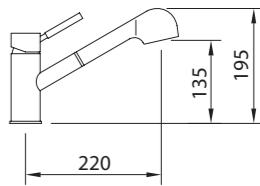
Mezclador con ducha extraíble, caño giratorio, flexibles M-10 3/8" x 370 mm.
