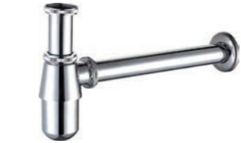
Sifón horizontal de botella de 1 1/4" para lavabos de encima, longitud de tubo horizontal 300 mm, longitud de tubo vertical 150 mm, tubo de 32 mm Ø.
