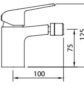
Mezclador con aireador a rotula y flexibles M-10 3/8" x 420 mm.
