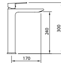
Mezclador alto con aireador y flexibles M-10 3/8" x 370 mm.
