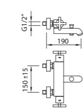
Mezclador baño-ducha, aíreador, inversor automático
