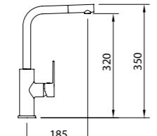
Mezclador con aireador, caño giratorio, flexibles M-10 3/8" x 370 mm.
