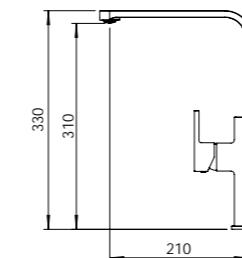
Mezclador con aireador, caño giratorio, flexibles M-10 3/8" x 500 mm.
