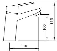
Mezclador con aireador y flexibles M-10 3/8" x 420 mm.
