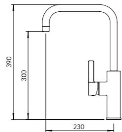
Mezclador con aireador, caño giratorio, flexibles M-10 3/8" x 500 mm.
