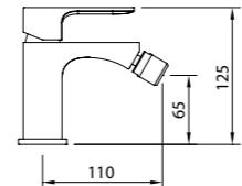
Mezclador con aireador a rótila, flexibles M-10 3/8" x 420 mm.
