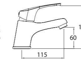
Mezclador con aireador y flexibles M-10 3/8" x 420 mm.
