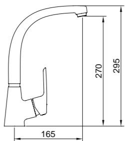
Mezclador con aireador, caño conformado giratorio, flexibles M-10 3/8" x 370 mm.
