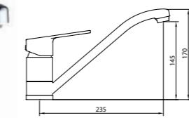
Mezclador con aireador, caño giratorio y flexibles M-10 3/8" x 370 mm.
