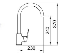
Mezclador con aireador, caño fundido giratorio, flexibles M-10 3/8" x 500 mm.
