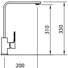
Mezclador con aireador, caño tubo giratorio, flexibles M-10 3/8" x 370 mm.
