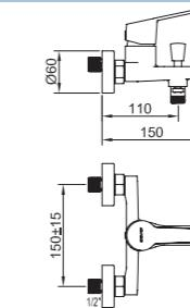
Mezclador con aireador baño-ducha, inversor automático.
