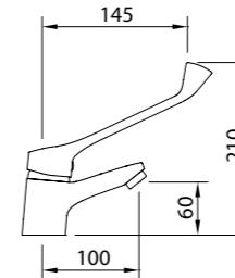
Mezclador con aireador,con palanca gerontológica y flexibles M-10 3/8" x 370 mm.
