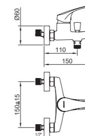
Mezclador con aireador baño-ducha, inversor automático.
